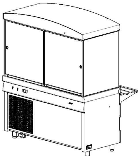
В тумбе размещается компрессор, конденсатор и элементы монтажа холодильной установки. Для надежной работы компрессора **необходимо не реже одного раза в месяц** производить очистку радиатора конденсаторного блока (например, пылесосом), для чего с фасадной стороны агрегатного отсека имеется съемная панель.
