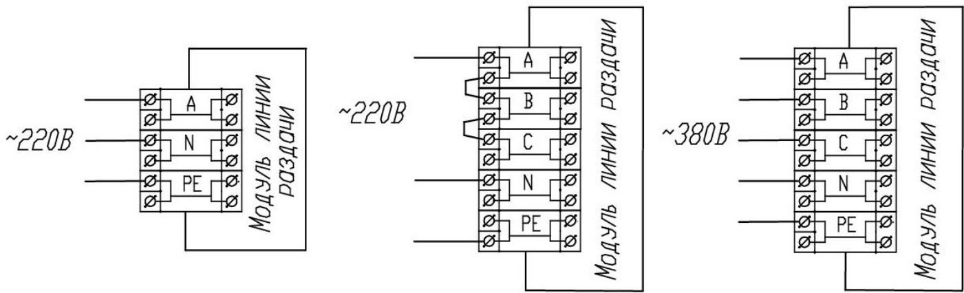
Автоматический выключатель и сечение подключаемого кабеля должны быть рассчитаны на ток номинальной нагрузки модуля, установленного в линию раздачи.
