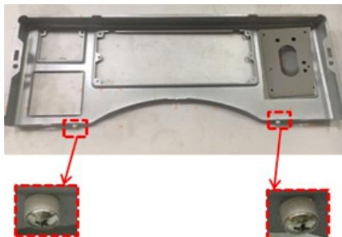
1) Откройте панель управления ключом, затем отвинтите четыре винта и снимите пластину панели управления.
