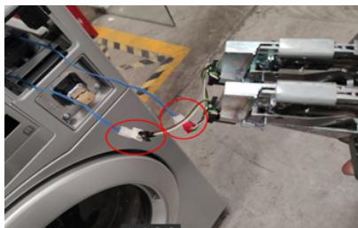
7) Короткий провод должен быть подключен к стиральной машине с расположенным справа счетчиком монет. Длинный провод должен быть подключен к сушильной машине с расположенным слева счетчиком монет.
