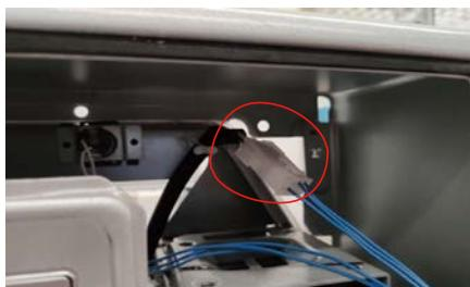
8) Протяните жгут проводов через проволочный зажим, затем зафиксируйте крышку монетоприемника при помощи ключа.
