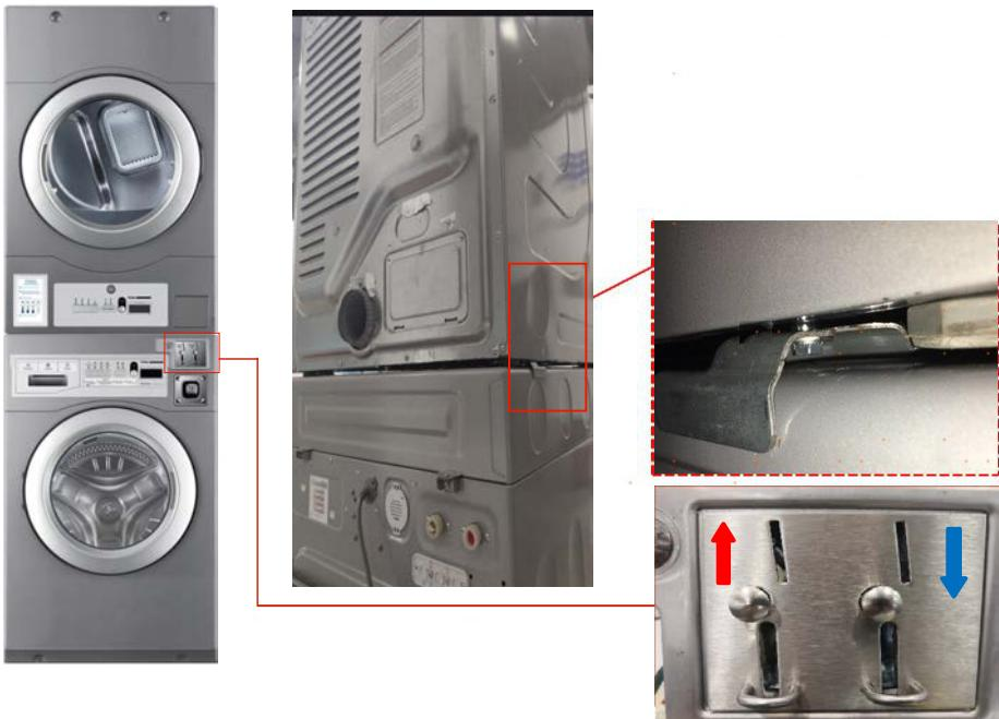
Установите перевернутую сушильную машину на верхнюю панель опорной стиральной машины. Необходимо выровнять четыре самонарезающих ступенчатых винта относительно пазов крепежной пластины и путем давления сзади на перевернутую сушильную машину, выровнять машины относительно друг друга спереди и сзади.
