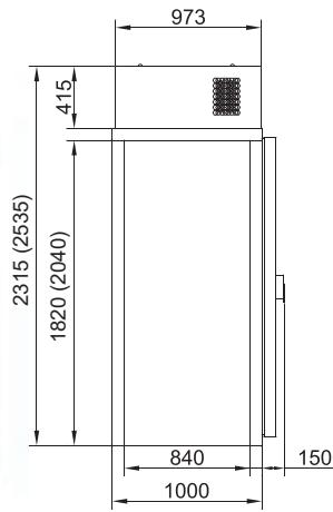
4. Камеры без пола с двумя дверными блоками. Выполняются в среднетемпературном (-5...+5°C) режиме.
