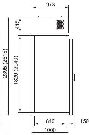
2. Камеры с полом и двумя дверными блоками. Выполняются как в среднетемпературном (-5...+5°C), так и в низкотемпературном (до -23°C) режимах.
