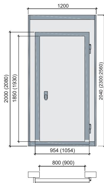
Возможно изготовление дверного блока с размером светового проема 900x1930
