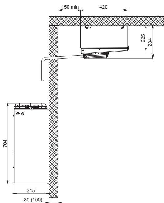
**Сплит-системы POLAIR серии Professionale (P)** – профессиональные высокотехнологичные холодильные машины с муфтовыми соединениями выходов блоков и соединительных трубок, воздухоохладителем новой конструкции, выносным пультом управления. Поставляются заправленными хладагентом. В зависимости от размеров корпуса выполняются двух типоразмеров.
