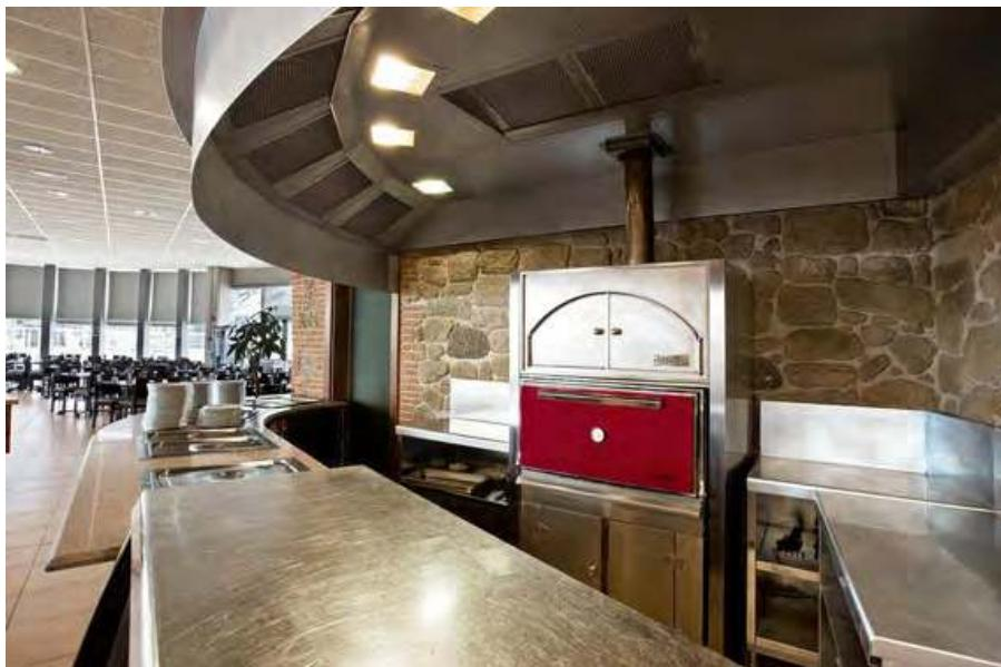
В этом случае на конце дымового выхода печи устанавливается канал с непосредственным выходом наружу. Тем не менее остается необходимость установки пламегасителя, а также зонта для вытягивания дыма, возникающего в процессе готовки. Далее следуйте советам, изложенным ранее.
