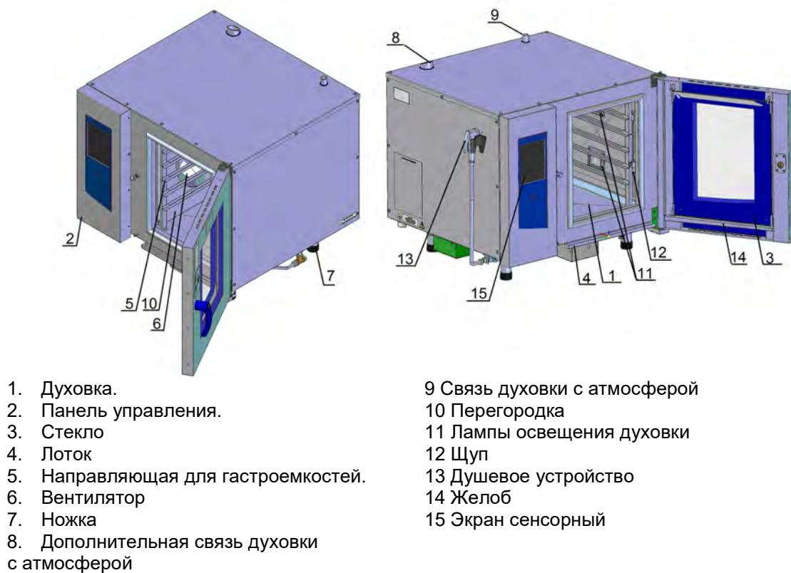
Рисунок 1. Общий вид пароконвектомата
