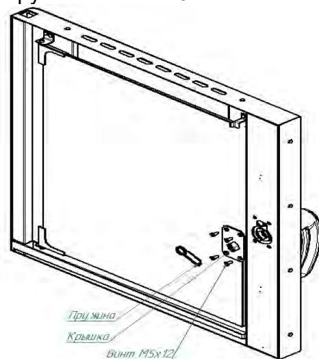
Рис. 18. Ремонт замкового устройства
