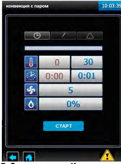
Рис. 7. Экран режим «Конвекция + Пар»
