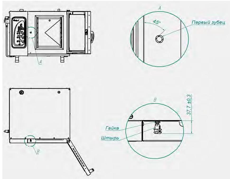
Рис. 19. Регулировка замкового устройства
