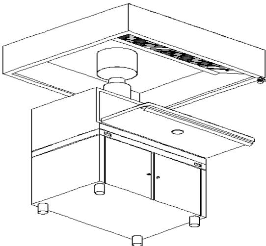
Гидрофильтр с системой вентиляции необходимо соединять металлическим дымоходом Ø 315 мм. Если часть дымоотводной трубы, выходящей из фильтра, имеет горизонтальное положение, следует создать минимальный уклон 5% для стока из неё конденсата.
