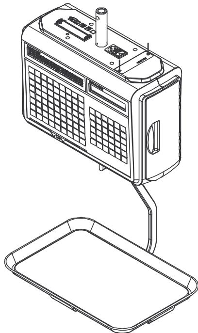
Рисунок 1.4 – Контурный вид подвесной модификации (H)
