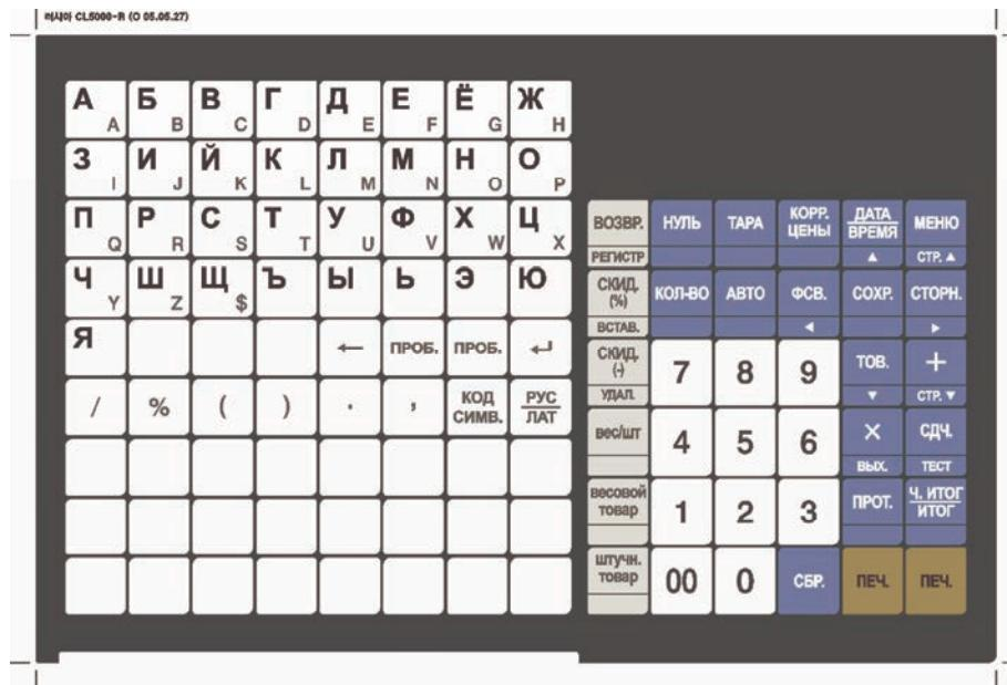
Рисунок 1.9 – Вид клавиатуры весов подвесной модификации
