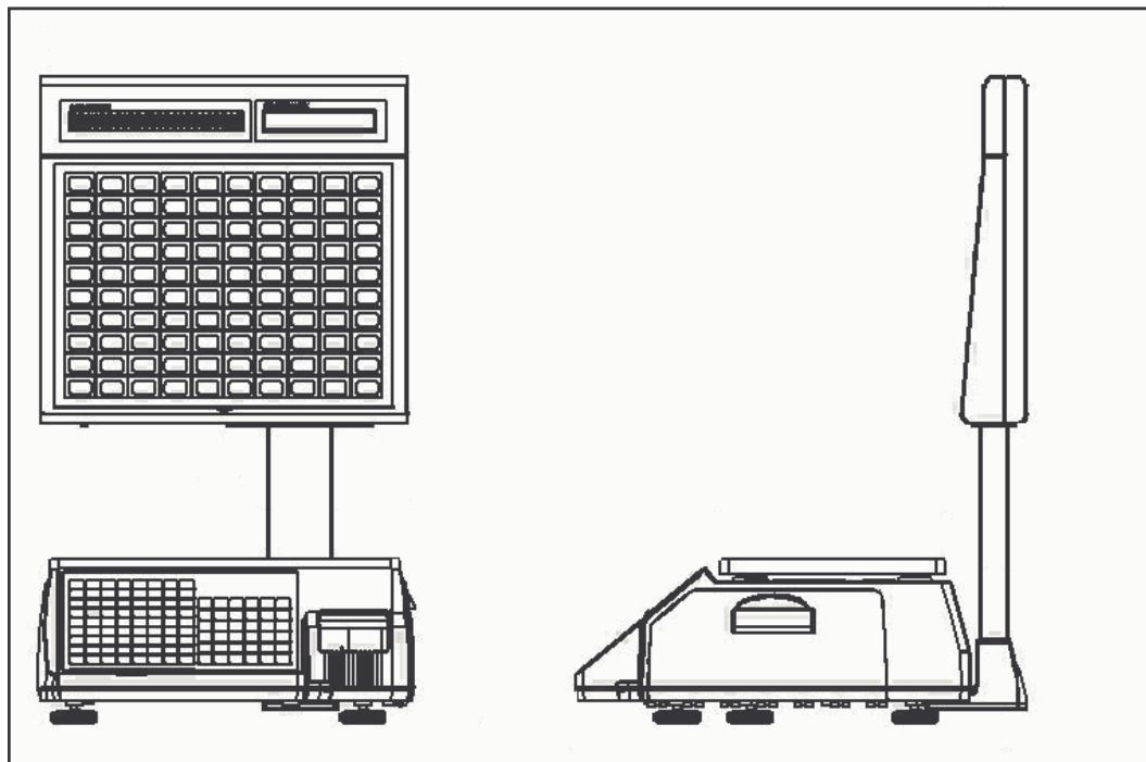
Рисунок 1.5 – Контурный вид весов с дополнительной клавиатурой самообслуживания
