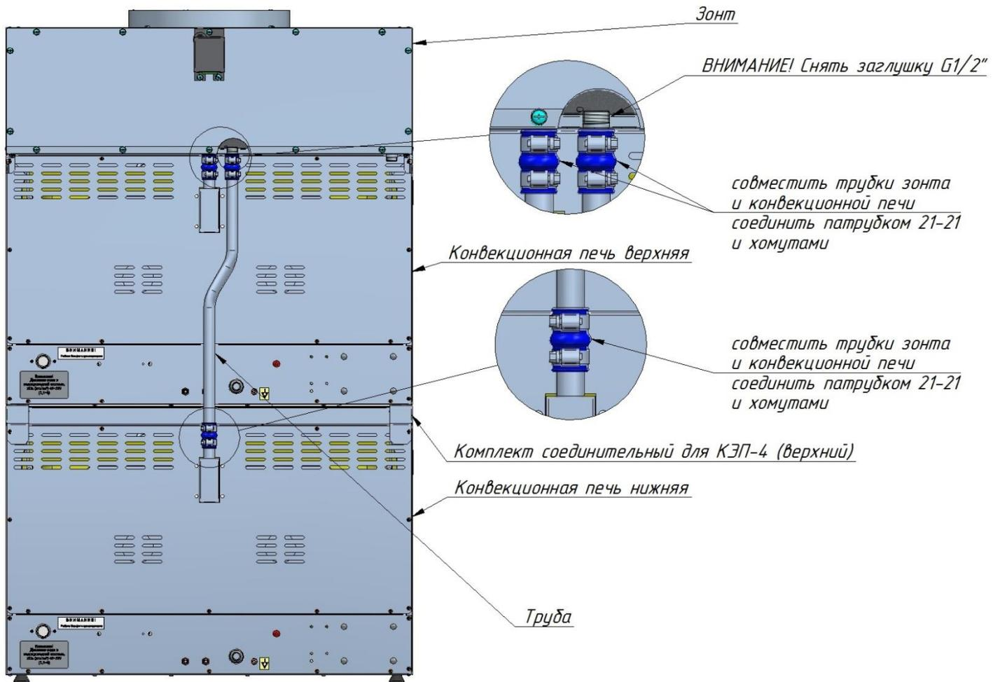
Рис.4 Установка зонты совместно с двумя конвекционными печами.
