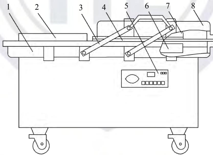
1. Рабочая камера 2. Планка запайки (Пластина) 3. Соединительный шток 4. Уплотнитель крышки 5. Панель управления 6. Устройство для запайки (двухкамерное) 7. Прижимная планка 8. Крышка вакуумной камеры
