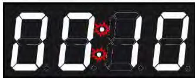
Если в процессе приготовления будет открыта дверь аппарата, автоматически прекратится отсчет времени, а на центральном экране отобразится соответствующая индикация:
