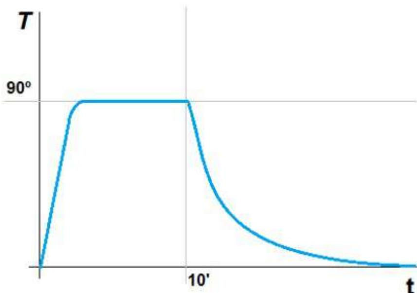
График изменения температуры в камере аппарата.
