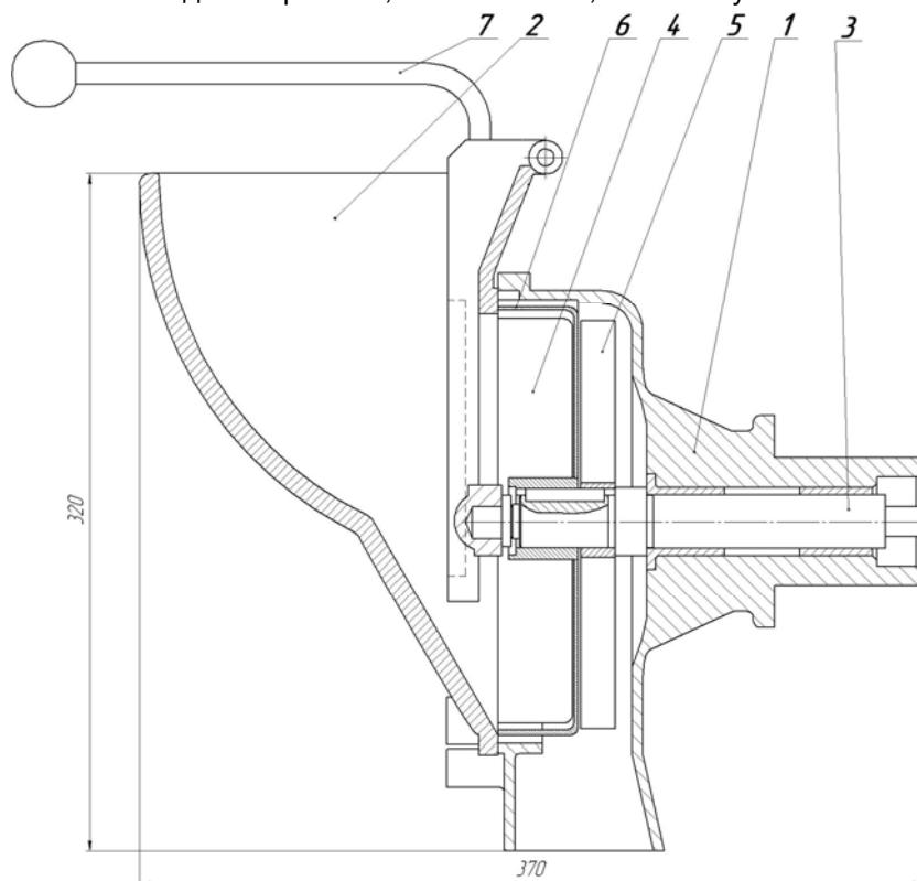
**Рисунок 32 – Протирочный механизм, механизма МО –1**
