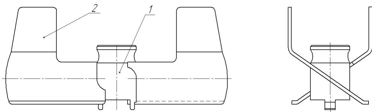
**Рисунок 15 – Ротор лопастной**
