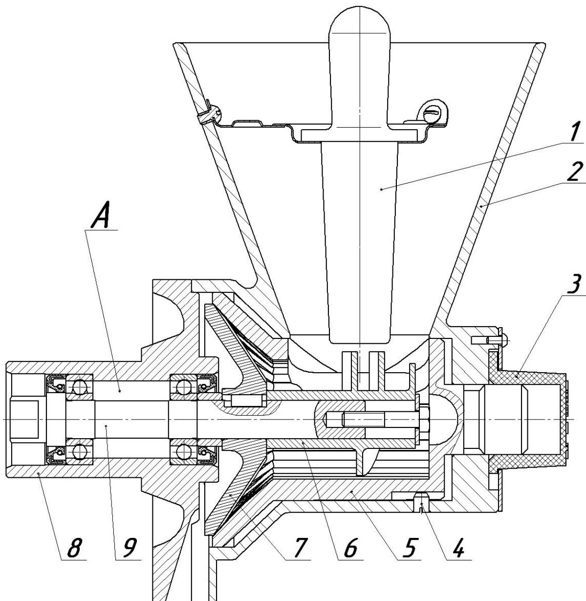
Рисунок 23 – Механизм для измельчения сухарей и специй МИ
