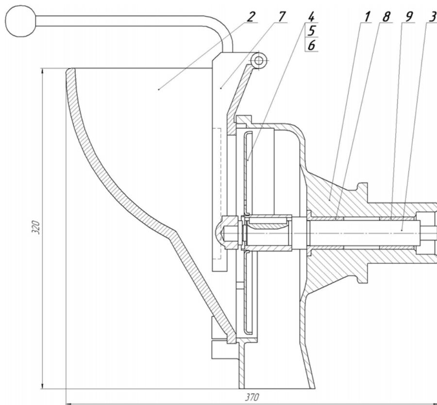
**Рисунок 31 – Овощерезательный механизм, механизма МО –1**
