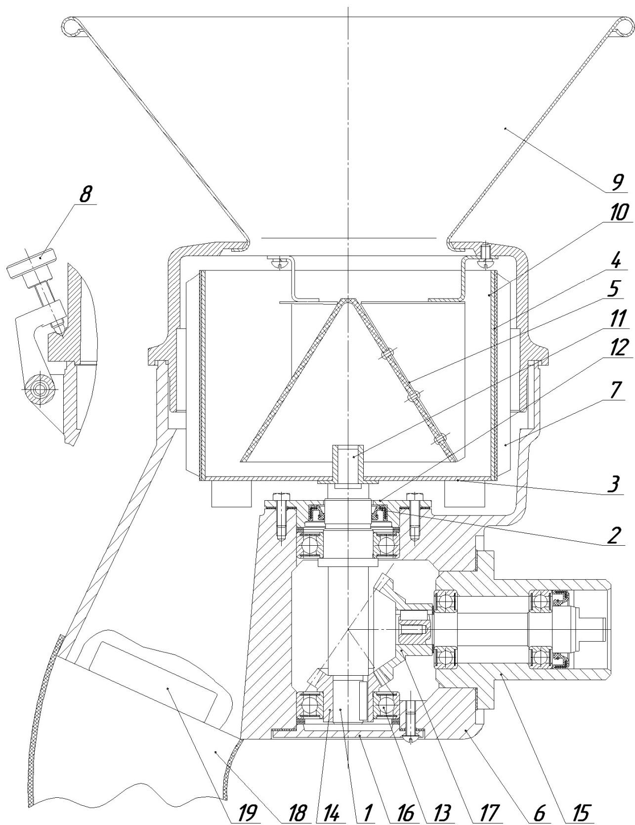
**Рисунок 19 – Просеиватель МП – 01**
