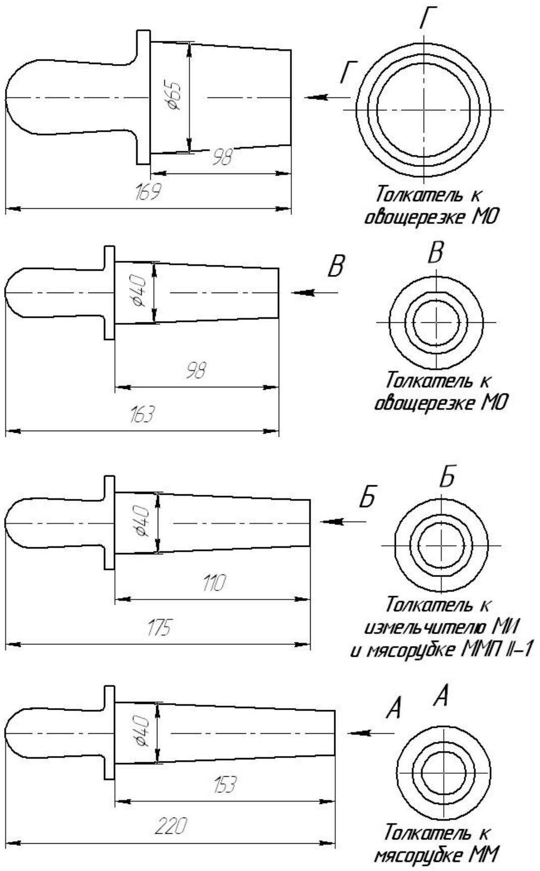
Рисунок 30 – Принадлежности к механизмам машины УКМ
