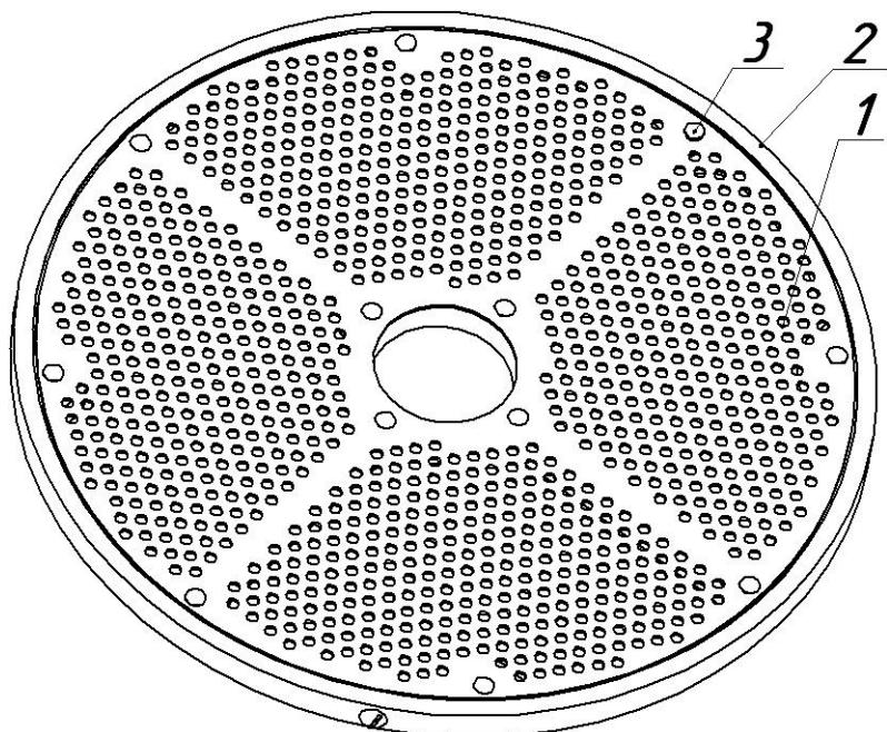
**Рисунок 16 – Диск протирочный**
