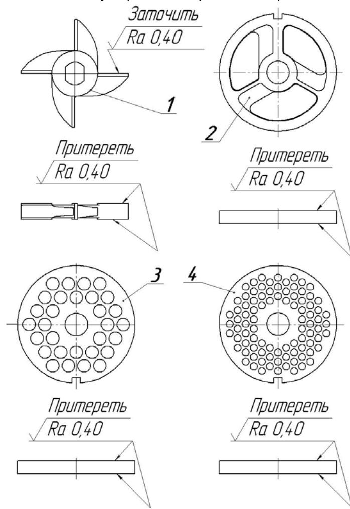
**Рисунок 5 – Нож и решетки мясорубки ММ**
