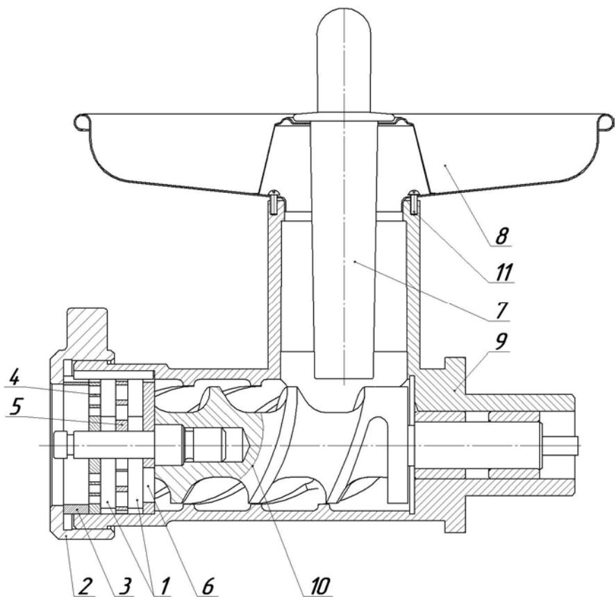
**Рисунок 2 – Мясорубка ММ**
