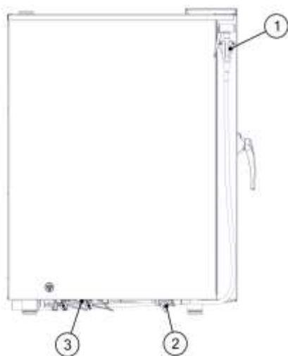
Рис.3 - Схема подключения душа ручного и расположение трубок насосов-дозаторов.
