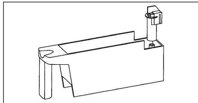
Вытащить сифон, промыть его теплой водой, после чего вставить на место.
