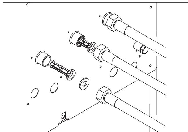
Прежде чем привернуть к машине заливные шланги, следует установить имеющиеся в прилагаемой упаковке сетки фильтров и уплотнители.
