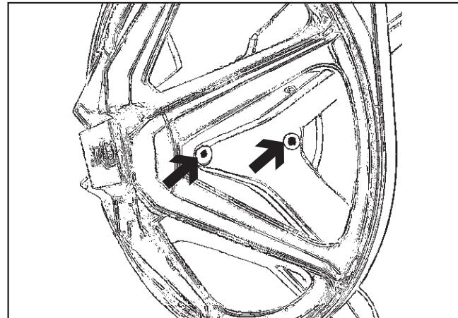
**Подшипник барабана** смазывается примерно через 1000 часов эксплуатации через специальные штуцеры маслом **Arcanol L 100**.
