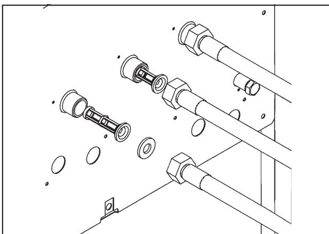
**Сетки** фильтров в клапанах для залива воды необходимо время от времени проверять и при их загрязнении очищать.
