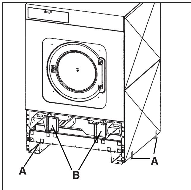
Удаляются боковые крепящие уголки "A" (по 2 справа и слева), закрепленные каждый одним винтом с шестигранной головкой. 2 передних и 2 задних крепящих уголка "B" закреплены каждый 3-мя винтами с шестигранной головкой и удаляются только на месте установки перед запуском стиральной машины.
