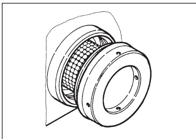
■ После того, как моющий раствор перестанет вытекать, полностью открутите крышку с фильтра. Этим Вы одновременно удалите сетку из фильтра.
