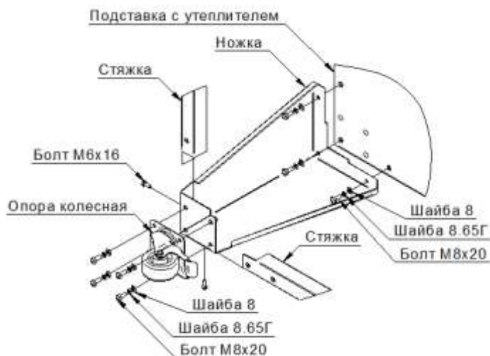
Рис. 4 - Схема сборки подставки
