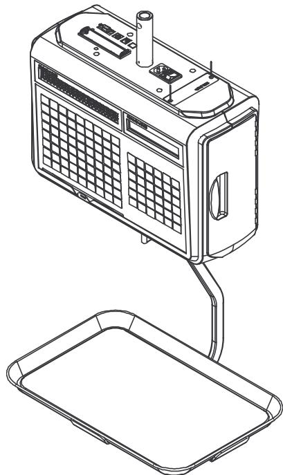
Рисунок 1.4 – Контурный вид подвесной модификации (CL5000J-IH)
