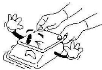
Контролируйте горизонтальность установки весов по ампуле уровня. Для регулировки используйте 4 винтовых ножки весов.
