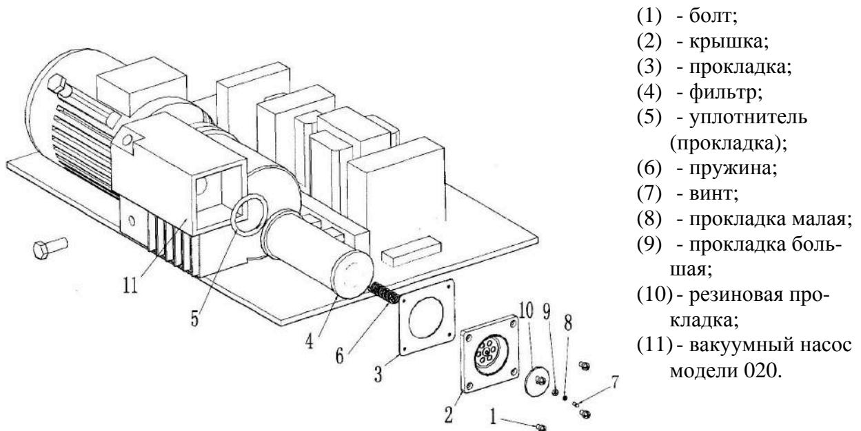
Рисунок 7.3 - Схема элементов вакуумного насоса модели 020
