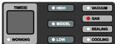
**Примечание.** Функция газации доступна не во всех моделях вакуумных упаковщиков (модуль заполнения газовой смесью заказывается отдельно). Если вакуумный упаковщик не укомплектован системой газации, установка времени данного режима автоматически пропускается.
