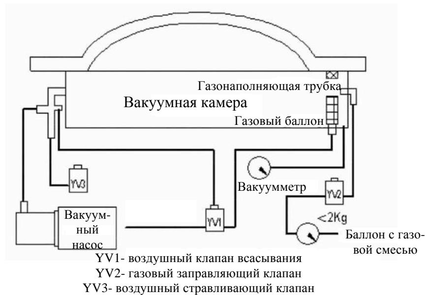
Схема вакуумного упаковщика с системой газации
