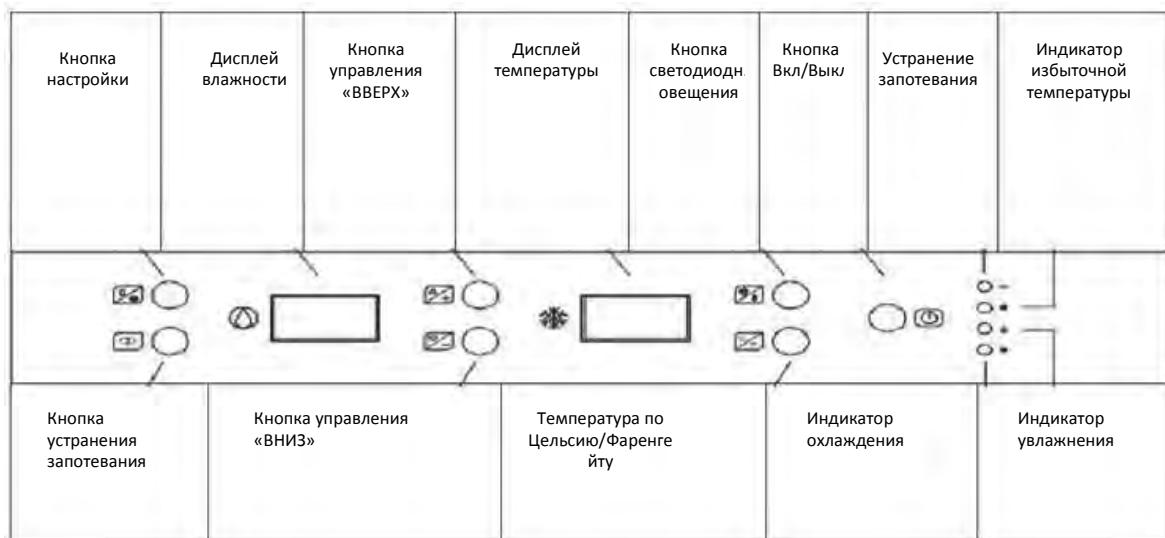
2. **Электропитание:** Нажмите кнопку ВКЛ/ВЫКЛ, чтобы включить шкаф. Нажмите ее еще раз, чтобы выключить его.
