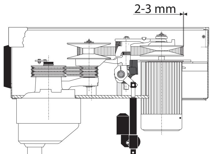
Рис. 7б Положение клинового ремня при максимальной скорости.
