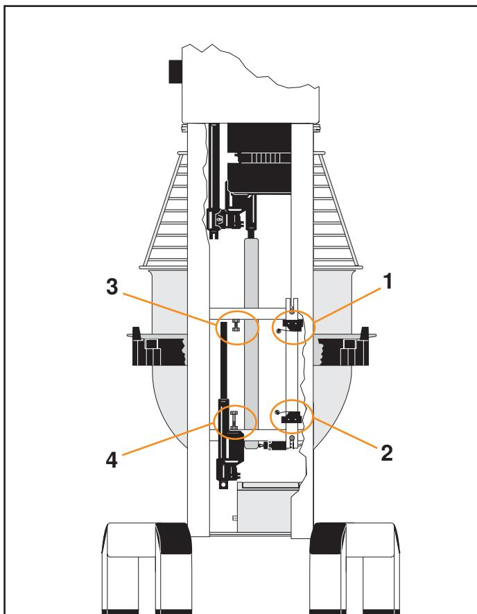
Рис. 6а Регулировка высоты дежи:
