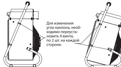
Рис. 2. Тепловентилятор
