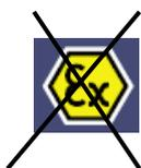
Взрывоопасная обстановка: атмосфера, чувствительная к взрывам, благодаря местным и/или рабочим условиям, считается потенциально взрывоопасной. Эта машина не была создана для работы в потенциально взрывоопасной обстановке.
