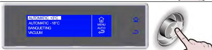
7. Выбрать поворачивая ручку желаемый цикл
