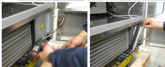
Удалить фиксирующие винты электрического щита.
