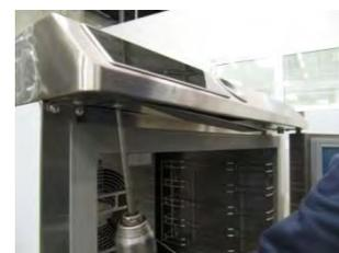
Ослабьте винты и снимите крышку для доступа к видеокарты и датчик
