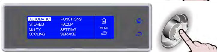
5. Выбрать желаемый тип цикла поворачивая ручку
