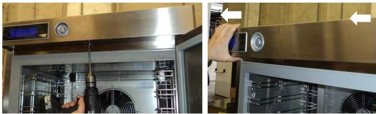
Ослабьте винты и снимите крышку для доступа к видеокарты и датчик
