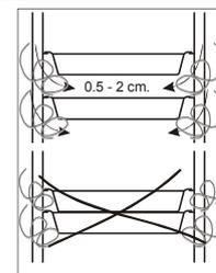
В моделях с тележками располагать структуру крепления решеток в центре камеры.
