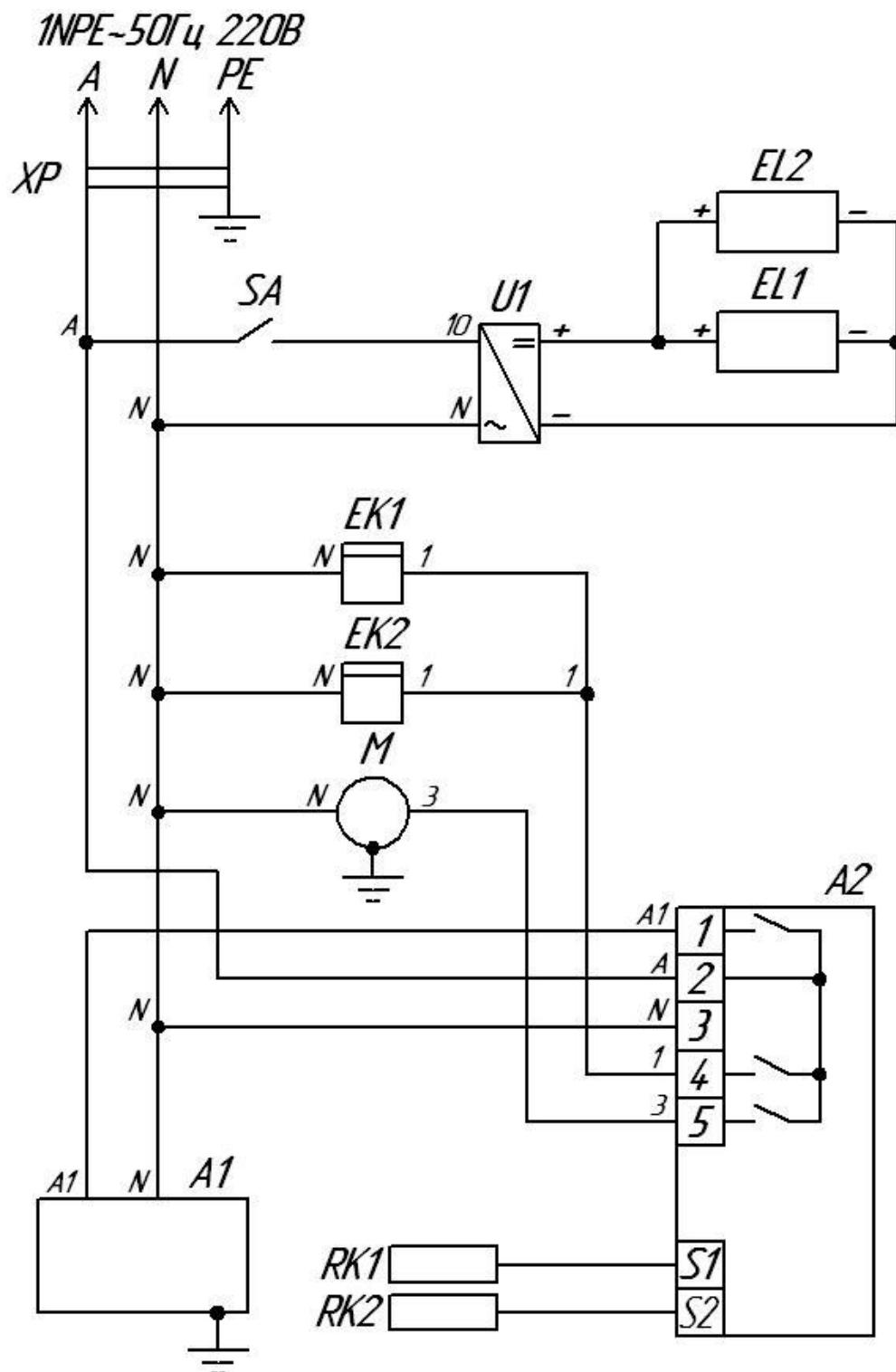
**A1** – компрессорно-конденсаторный блок; **A2** – контроллер; **EK1,EK2** – ТЭН испарителя и ПЭН слива; **EL1,EL2** – лента светодиодная; **M** – вентилятор испарителя; **RK1,RK2** – датчик температуры; **SA** – выключатель освещения; **U1** – источник питания для светодиодной ленты; **ХР** – шнур питания с вилкой.
