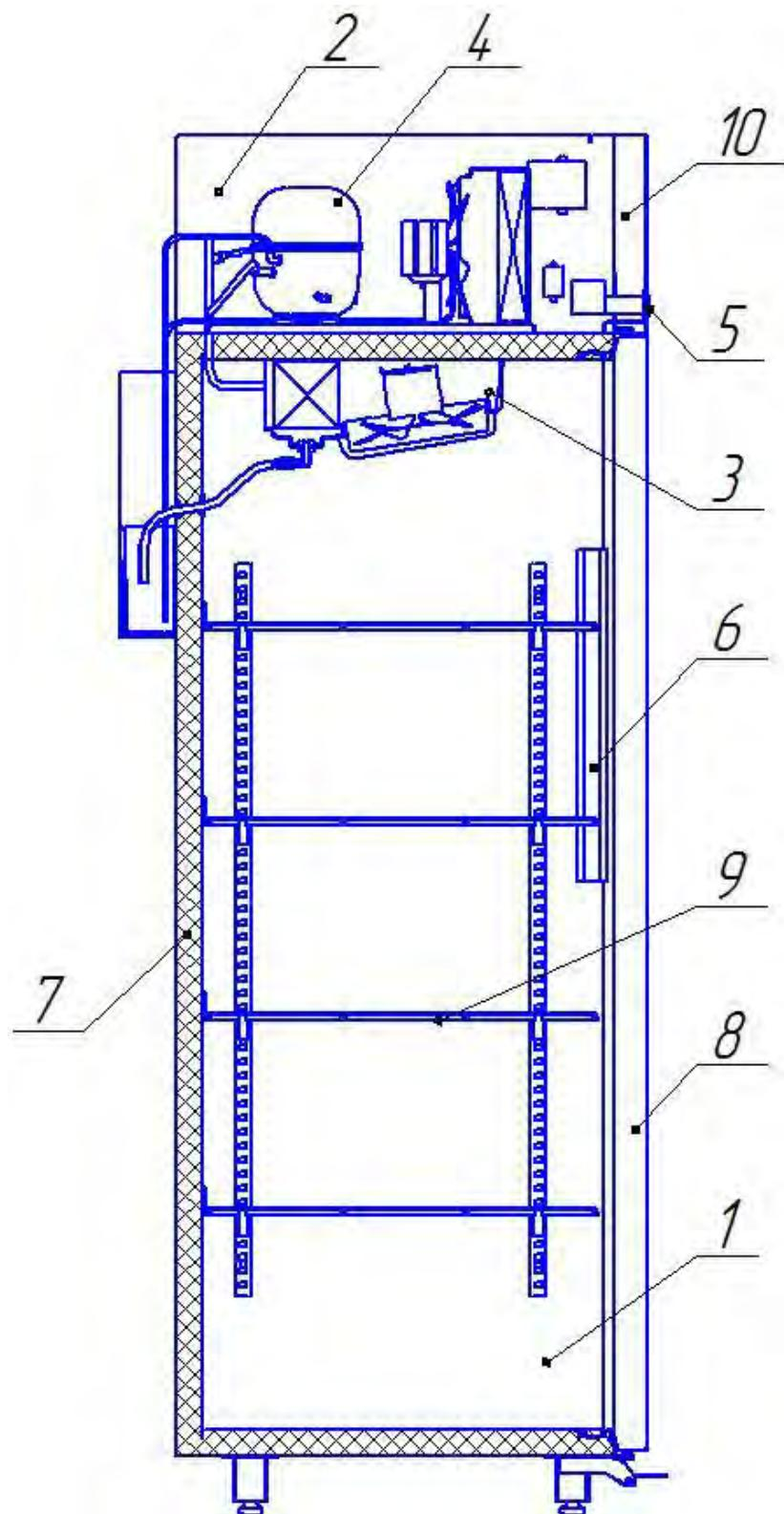
1. Полезный объём. 2. Машинное отделение. 3. Воздухоохладитель. 4. Компрессорно-конденсаторный блок. 5. Контроллер. 6. Светодиодный светильник. 7. Корпус. 8. Дверца. 9. Полка-решётка. 10. Щиток машинного отделения.
