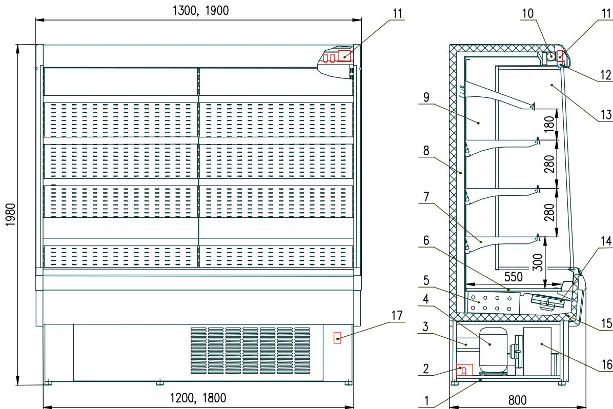
Рис. 1а. Схема витрины «СВИТИЯЗЬ П» ВС:
