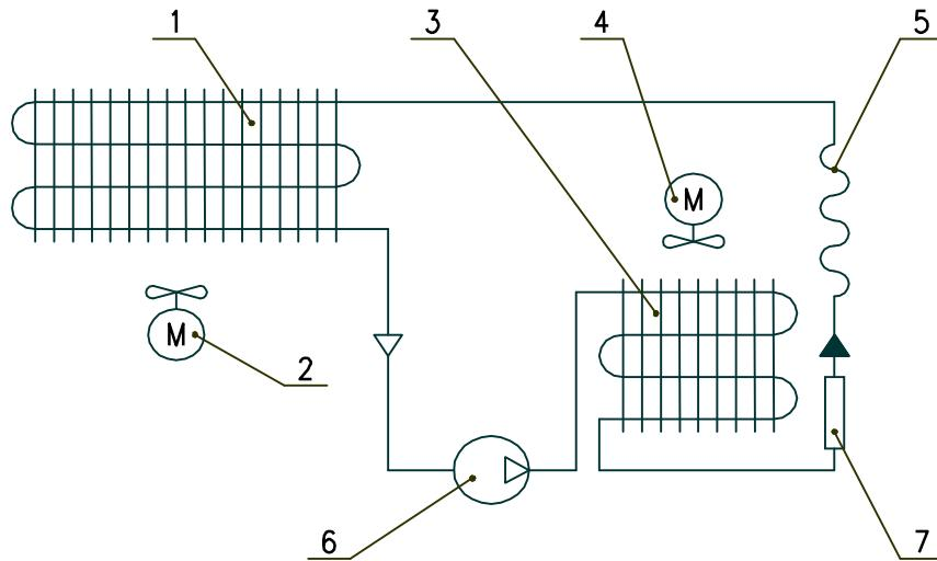
Рис. 3. Схема холодильной системы витрины со встроенным холодильным аг-
