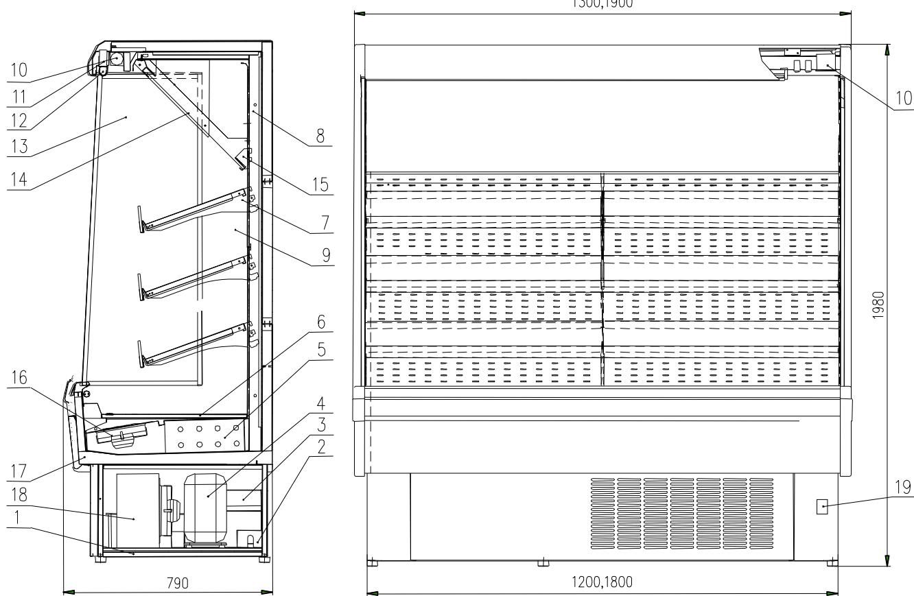
Рис. 16. Схема витрины «СВИТЯЗЬ П» ВВ:
