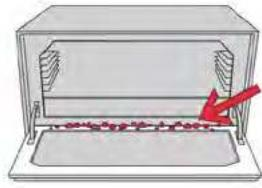
**Никогда не используйте воду для очистки пламегасителя.** Просто снимите и потрясите его, чтобы очистить от сажи и пыли, накопившихся внутри
