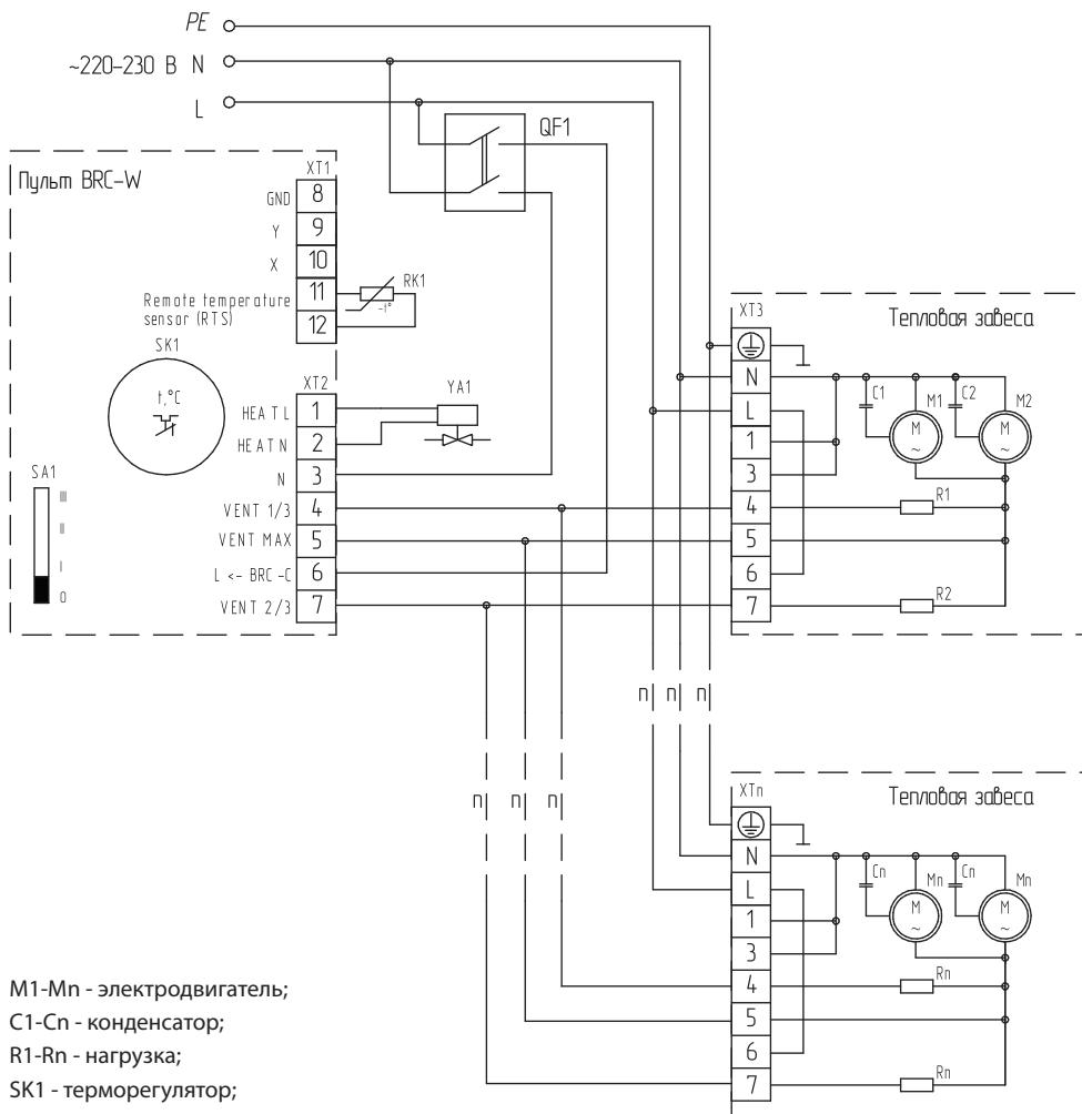
Групповое подключение тепловых завес BHC-M10W12-PS, BHC-M15W20-PS, BHC-M20W30-PS, BHC-H10W18-PS, BHC-H15W30-PS к пульту BRC-W производится аналогично.
