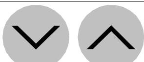
Нажимать кнопки и с платой в Off, на 4 секунды, чтобы войти в способ программирования параметров
