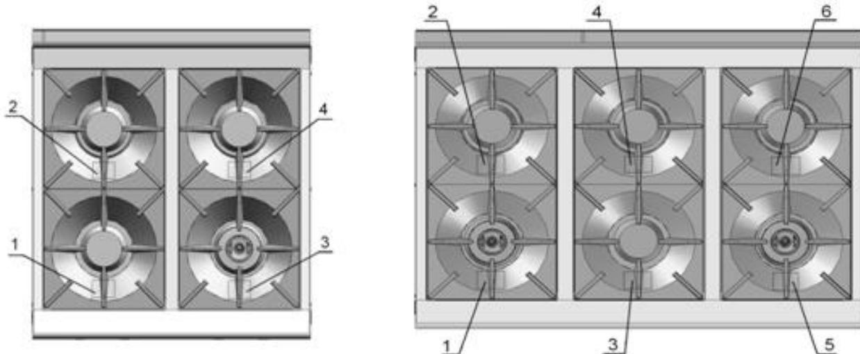
Рис 15. Схема установки и маркировка газовых решеток
