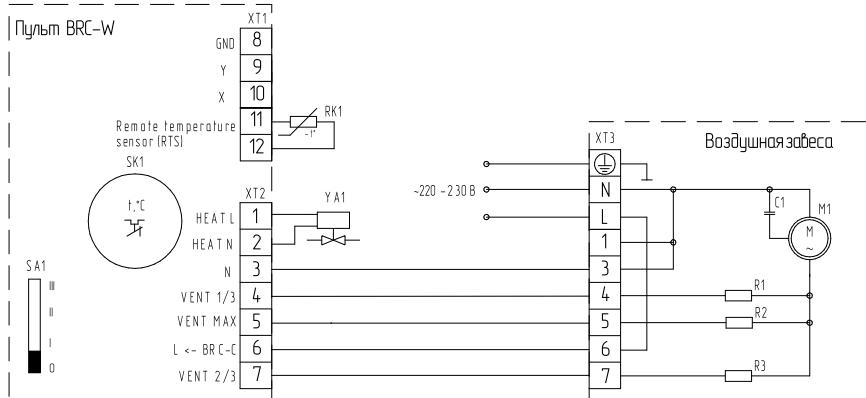
M1 - электродвигатель; C1 - конденсатор; R1-R3 - нагрузка; SK1 - терморегулятор, XT1-XT3 - колодка клеммная, SA1 - переключатель режимов вентиляции; RK1 - термодатчик; YA1 - электромагнитный привод двух-/трехходового вентиля.
