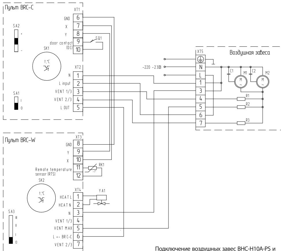
Подключение воздушных завес BHC-H10A-PS и BHC-H15A-PS с пультами BRC-W + BRC-C, производится аналогично.
