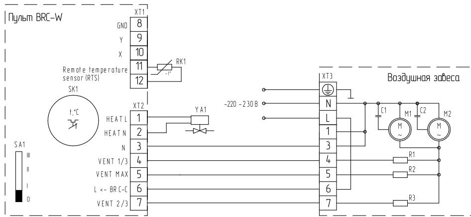
M1, M2 - электродвигатель; C1, C2 - конденсатор; R1-R3 - нагрузка; SK1 - терморегулятор;
