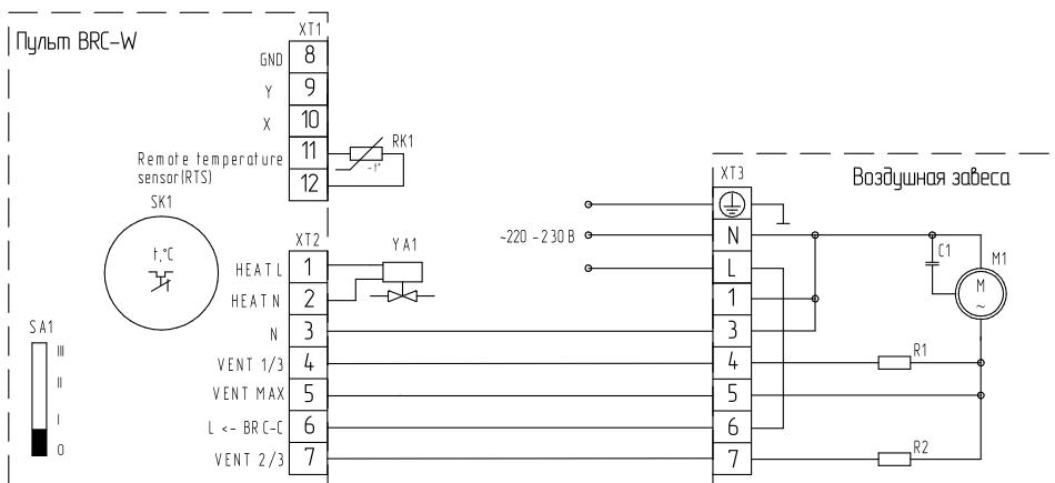
M1 - электродвигатель; C1 - конденсатор; R1, R2 - нагрузка; SK1 - терморегулятор; XT1-XT3 - колодка клеммная; SA1 - переключатель режимов вентиляции; RK1 - термодатчик; YA1 - электромагнитный привод двух-/трехходового вентиля.
